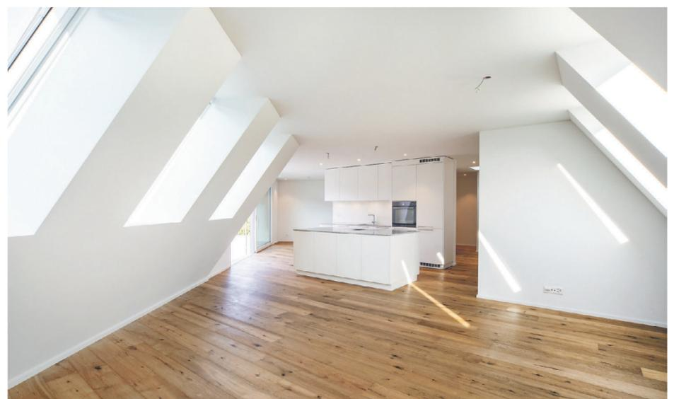
Die schräg betonierten Aussenwände dienen als Wärmespeicher
